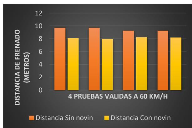
Figura 14. Comparación de la distancia de frenado a los 60km/h con Növin y sin Növin.
