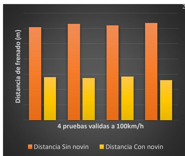
Figura 15. Comparación de la distancia de frenado a los 100km/h con Növin y sin Növin.
