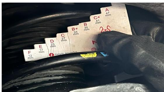
**Figura 1.** Regla y ejemplo de medición
