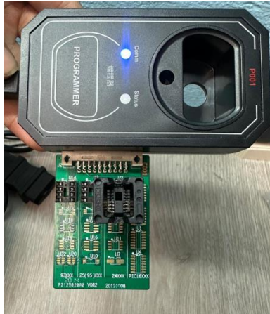
Colocación del adaptador en el equipo, Fuentes: Autores
