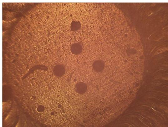
Figura 3. Medidas de los orificios del inyector TRAEN
