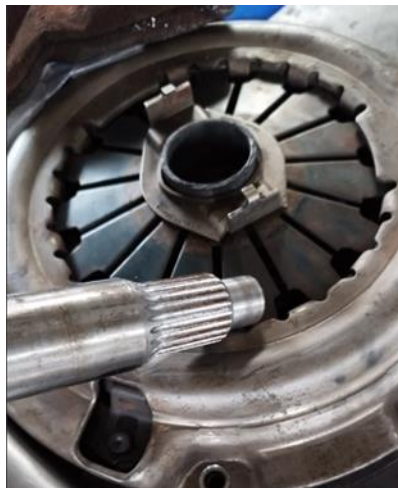
Figura 3.1 Adaptación eje primario de caja
