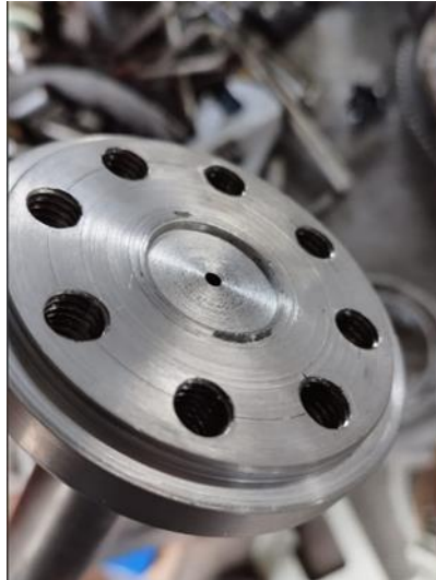
Figura 3.2- Pieza mecanizada para volante de inercia
