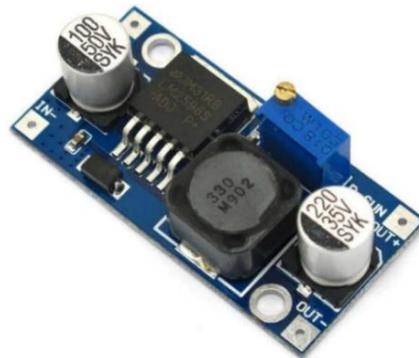
**Figura 16.** Regulador de voltaje LM2596 [64].
