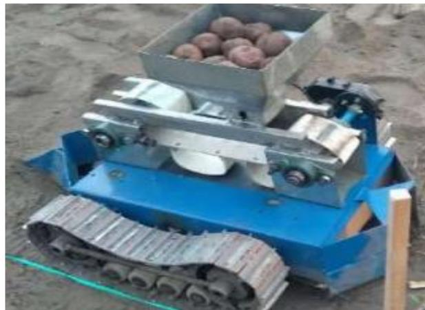
**Figura 2.** Robot sembrador de papa [8].
