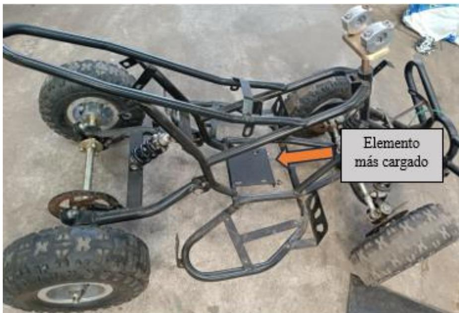
**Figura 38.** Elemento de carga.
