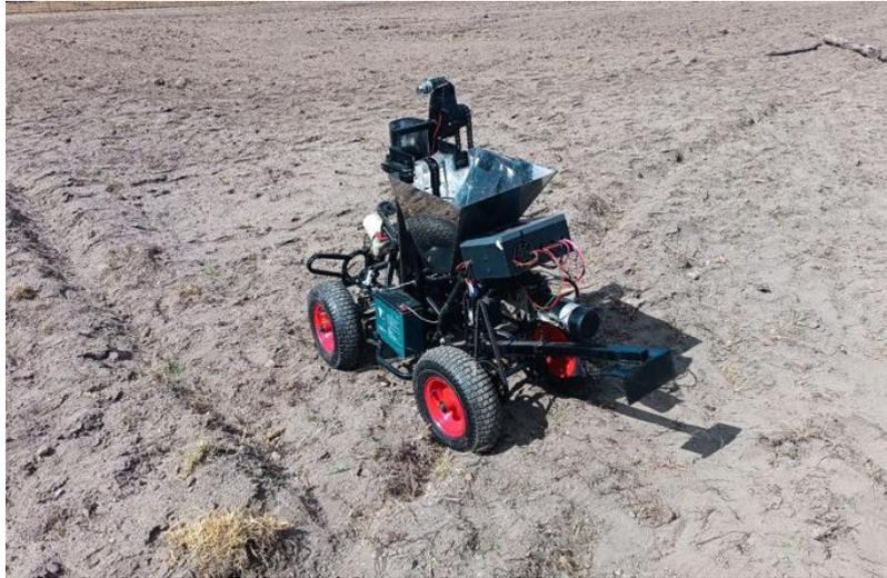
**Figura 61.** Robot móvil agricultor implementado.
