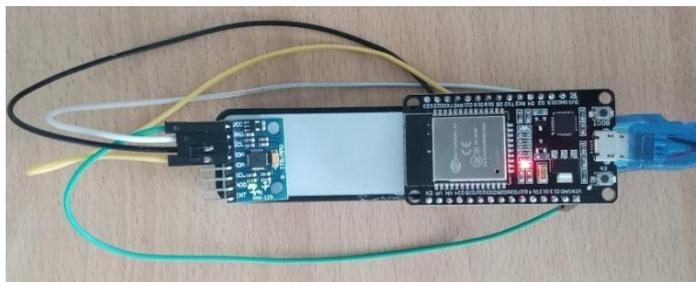
Conexión ESP32 – MPU6050. Fuente: (Autores)
