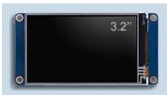
El gráfico muestra una pantalla táctil Nextion de 3.2 pulgadas, utilizada para interfaces gráficas en proyectos electrónicos. Fuente: (Repositorio,2020)
