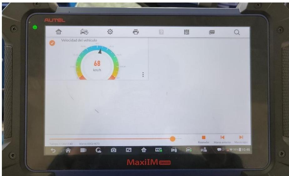
Datos obtenidos del vehículo con el scanner del Valor de la velocidad. Fuente: (Autores)
