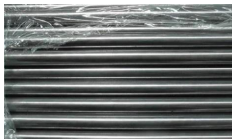
Figura 27: Tubo redondo 1½ de acero E255
