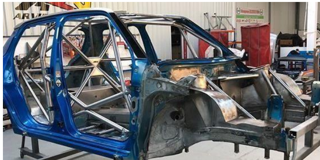
Figura 28: Jaula de seguridad hecha con tubos de Acero 1040
