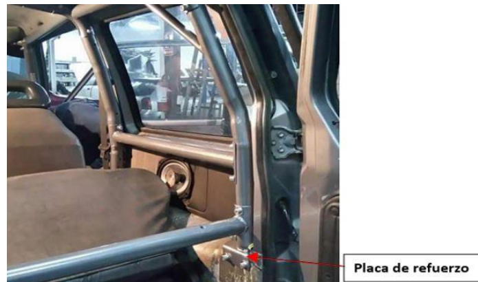
Figura 15: Placa de refuerzo fijada a la carrocería
