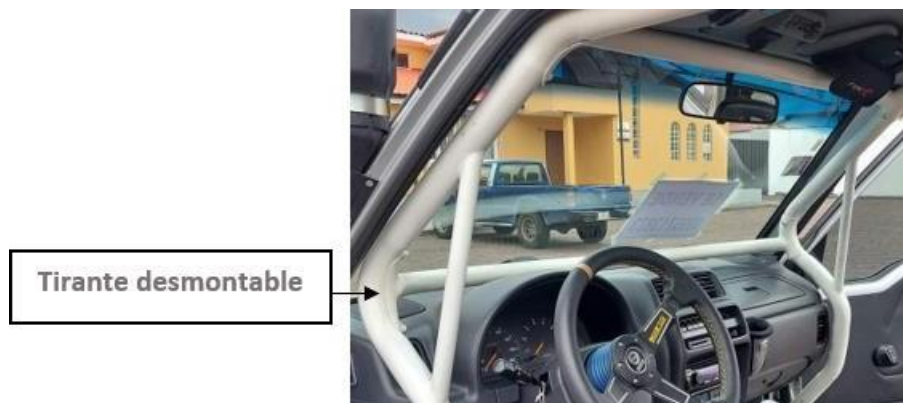
Figura 11: Tirante desmontable de la parte frontal
