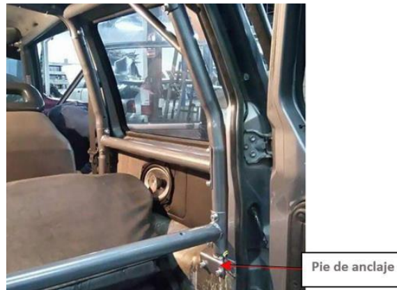
Figura 14: Pie de anclaje de tirante trasero
