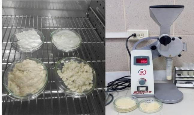
Nota: La imagen de la izquierda muestra las muestras en un horno y la imagen de la derecha muestra las muestras trituradas en el molino. Fuente: Autoras.
