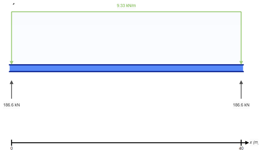
Figura 4-10 "Carga del carril sobre la viga de 40 m de longitud". Elaboración propia
