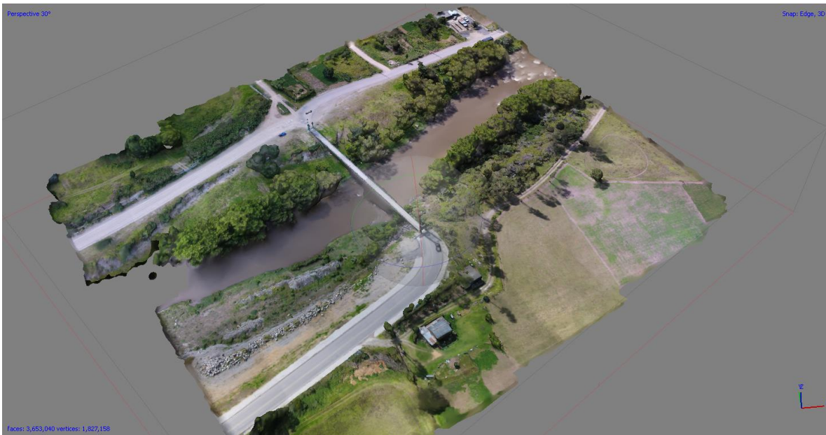
Figura 3-6 Modelación Topográfica mediante Fotogrametría. Elaboración propia
