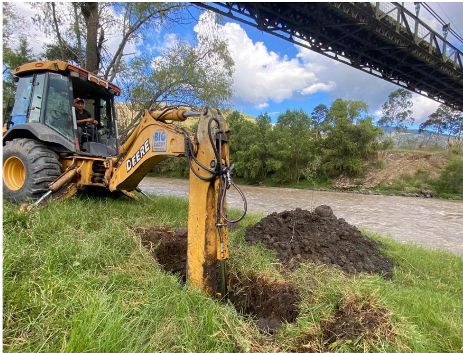
Figura 3-2 Obtención de muestra para realizar estudios en laboratorio (mayo-2024). Fuente: Autores
