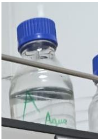
Figura 10: Fase móvil A, agua tipo 1 HPLC + ácido tricloroacético /TFA).
