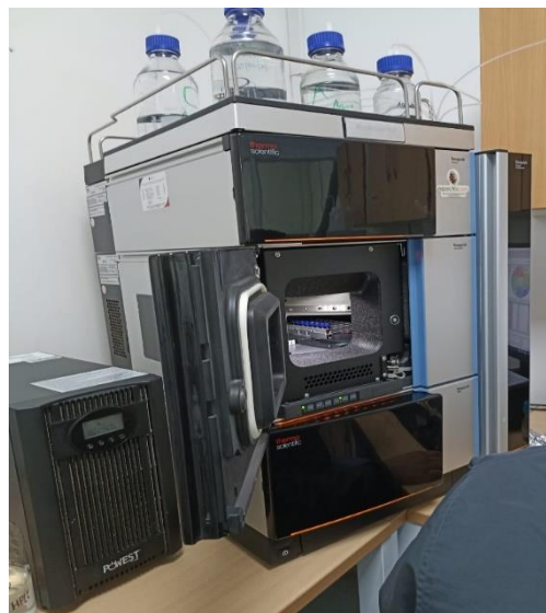
Figura 9: Cromatografía Líquida Alta Resolución de la marca Vanquish Flex / Vanquish Horizon.
