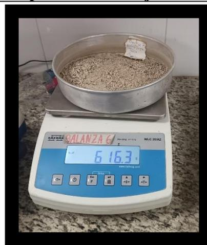
**Determinación de la densidad del agregado Grueso**
