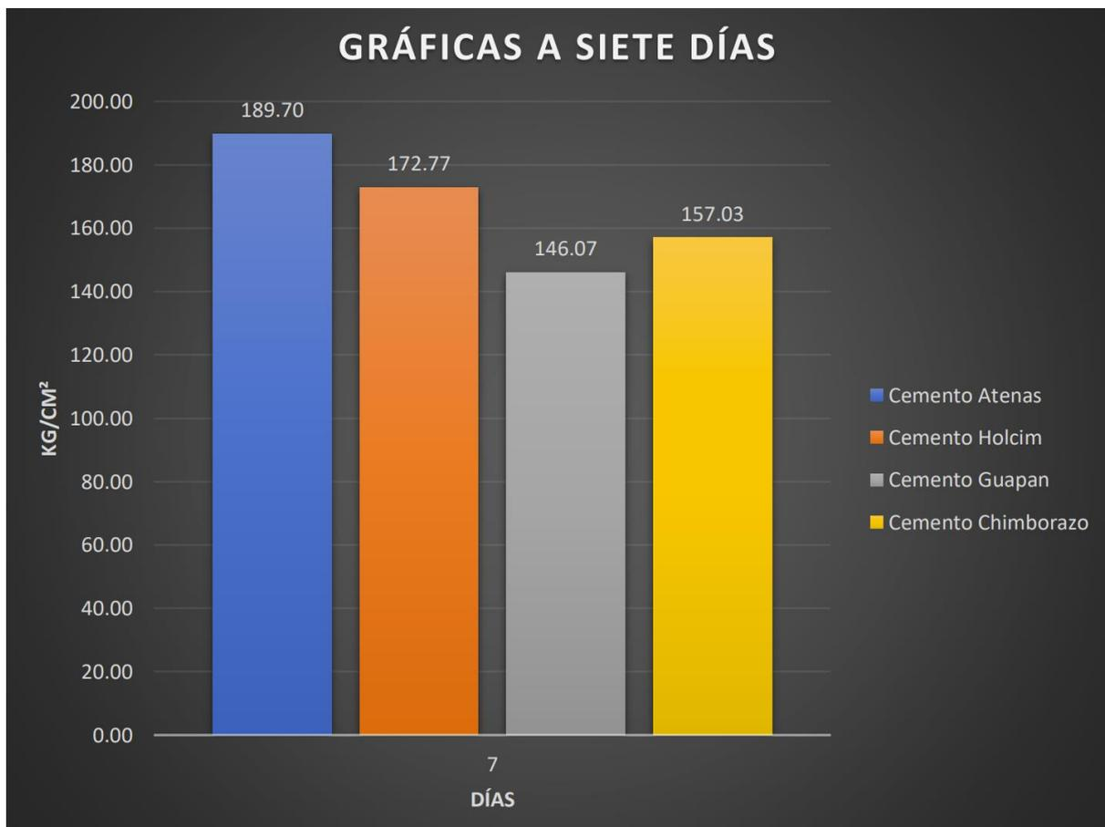
*Nota.* La figura muestra los resultados de la resistencia a la compresión alcanzada a los 7 días de curado de los cilindros elaborados con los 4 cementos descritos y los agregados utilizados de la mina RooKaazul. Elaborado por: Los Autores.
