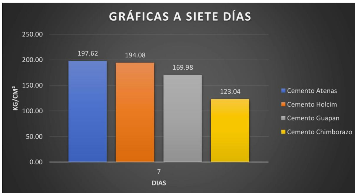
*Nota.* La figura muestra los resultados de la resistencia a la compresión alcanzada a los 7 días de curado de los cilindros elaborados con los 4 cementos descritos y los agregados utilizados de la mina SOMIGU. Además, se puede observar que el crecimiento alcanzado del concreto utilizando el cemento Atenas fue mayor, obteniendo un  $f'c$  de 197,62 kgf/cm<sup>2</sup>. Elaborado por: Los Autores.
