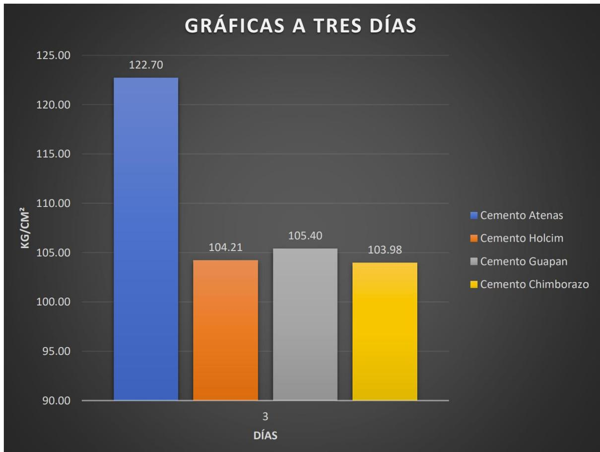
*Nota.* La figura muestra los resultados de la resistencia a la compresión alcanzada a los 3 días de curado de los cilindros elaborados con los 4 cementos descritos y los agregados utilizados de la mina RooKaazul. Además, se puede identificar que los cilindros de concreto realizados con el cemento Atenas brinda una mayor resistencia a la compresión a los 3 días a comparación de los demás, dándonos un  $f'c$  de 122,70 kg/cm<sup>2</sup>. Elaborado por: Los Autores.
