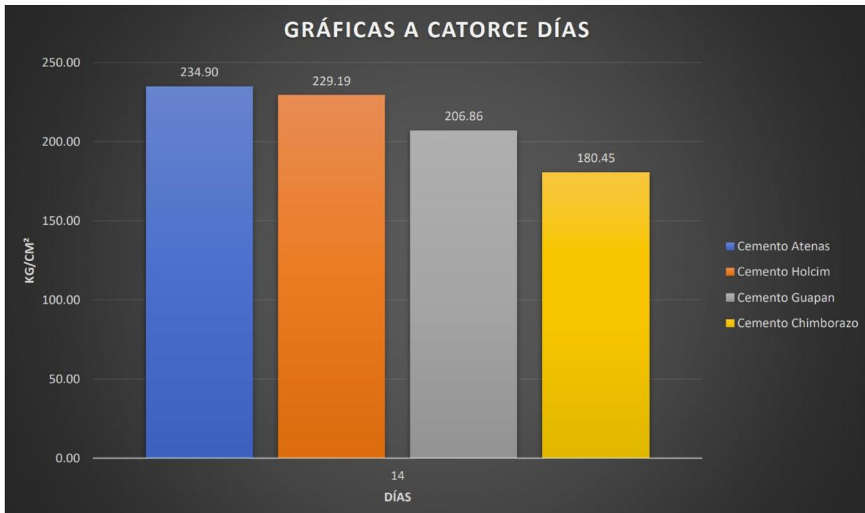
La figura muestra los resultados de la resistencia a la compresión alcanzada a los 14 días de curado de los cilindros elaborados con los 4 cementos descritos y los agregados utilizados de la mina SOMIGU. Además, se puede notar que el orden de crecimiento alcanzado del concreto sigue siendo el mismo. Elaborado por: Los Autores.
