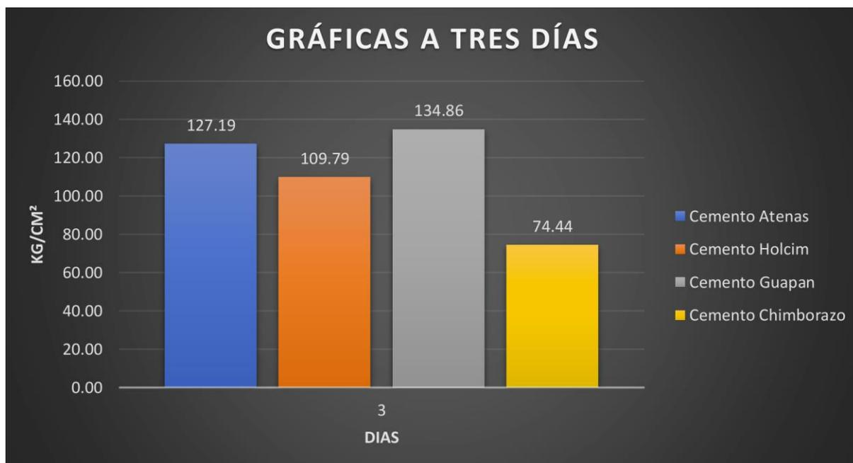
*Nota.* La figura muestra los resultados de la resistencia a la compresión alcanzada a los 3 días de curado de los cilindros elaborados con los 4 cementos descritos y los agregados utilizados de la mina SOMIGU. Además, se puede identificar que los cilindros de concreto realizados con el cemento Guapan brindan una mayor resistencia a la compresión a los 3 días a comparación de los demás, dándonos un  $f'c$  de 134,86 kg/cm<sup>2</sup>. Elaborado por: Los Autores.
