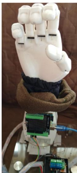
Nota. El dispositivo protésico implementado conjuntamente con la visión artificial.
