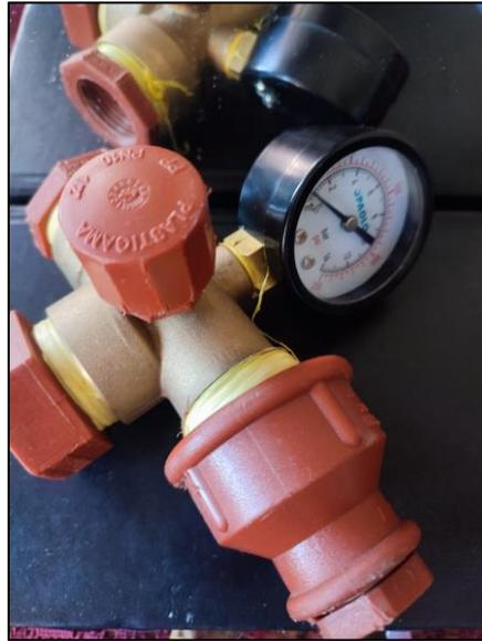
*Nota.* Se observa un manómetro conectado a un juego de accesorios para medir la presión, la capacidad de este es de 200 Psi. Elaborado por: Los autores.
