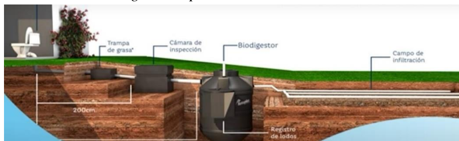
Figura 5 Esquema del Uso de un Biodigestor Séptico
