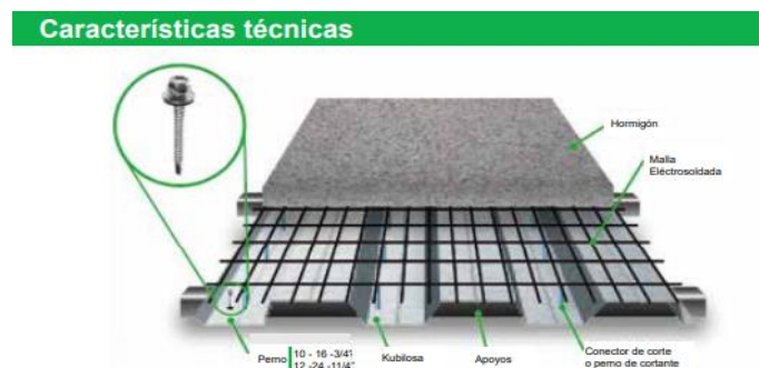
Figura 28 Características Técnicas de una Losa Colaborante
