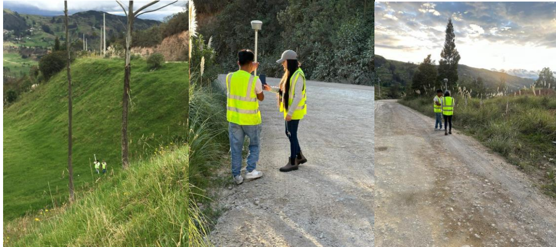
Ilustración 13 Levantamiento topográfico con RTK
