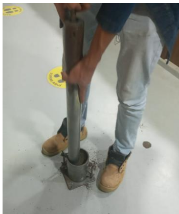
Figura 10. Ensayo de Proctor Modificado
