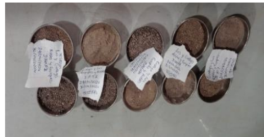
Figura 6. Muestras en estado seco, para el ensayo de Contenido de Humedad
