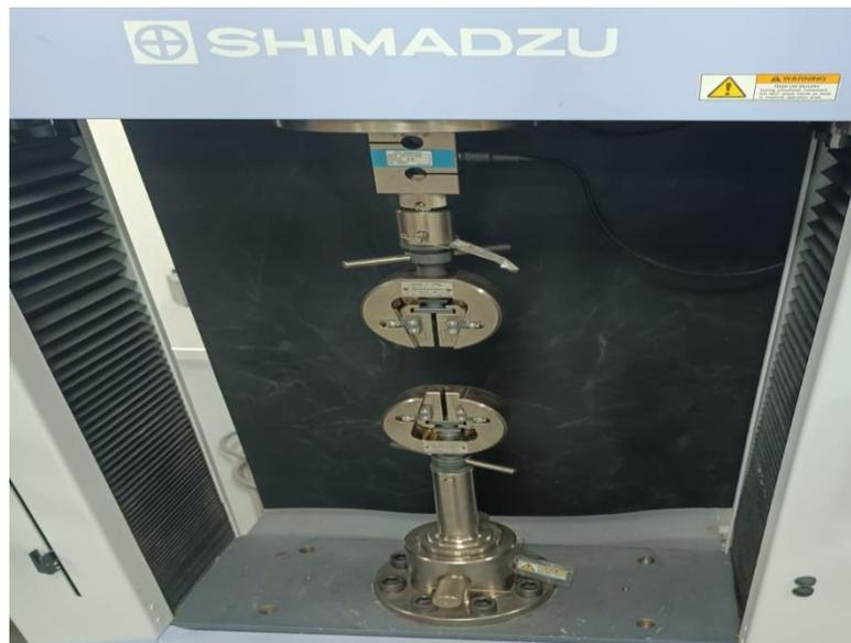
**Figura 31.** Máquina de ensayos universal.
