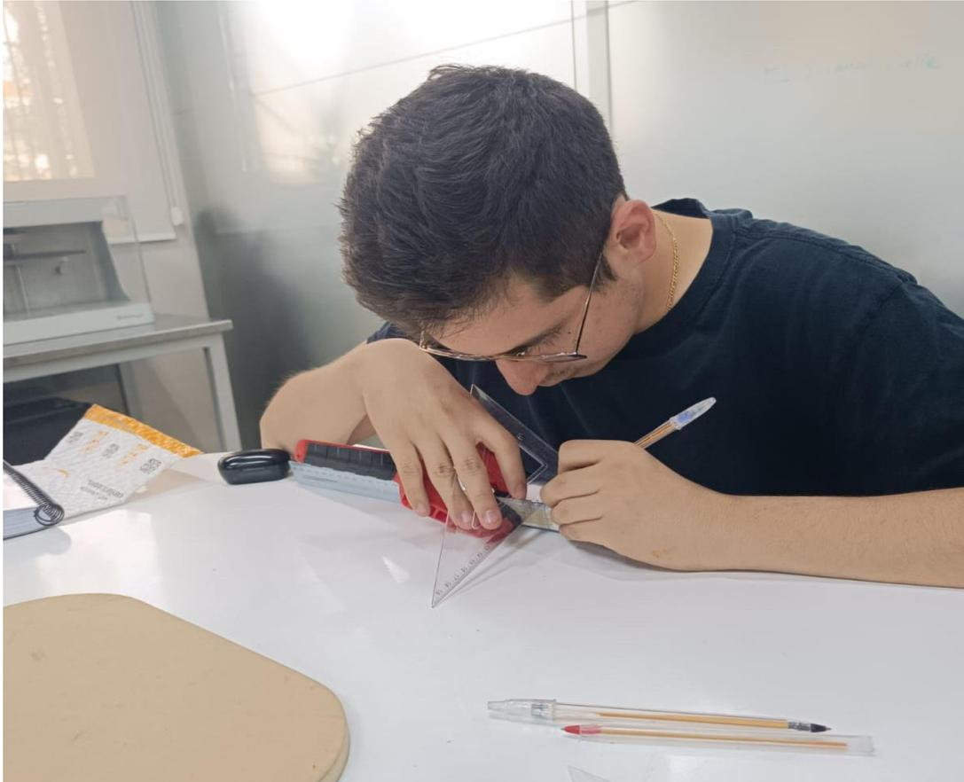
**10.22.** Trazado de las líneas de pre-grieta para el ensayo.
