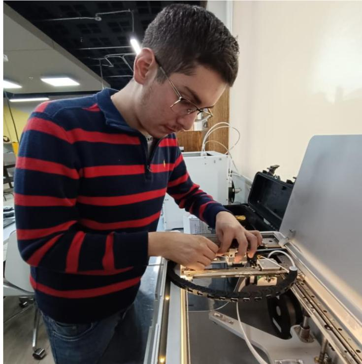
**Figura 18.** Remoción del Onix™ del extrusor de la impresora.
