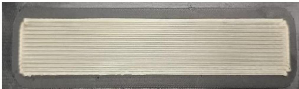
**Figura 19.** Primeras capas de fibra de vidrio
