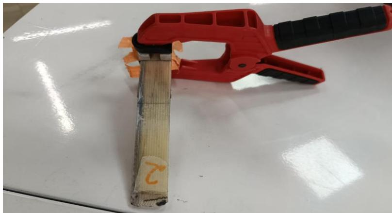
**Figura 29.** Prensa manual durante el proceso de curado del pegamento.
