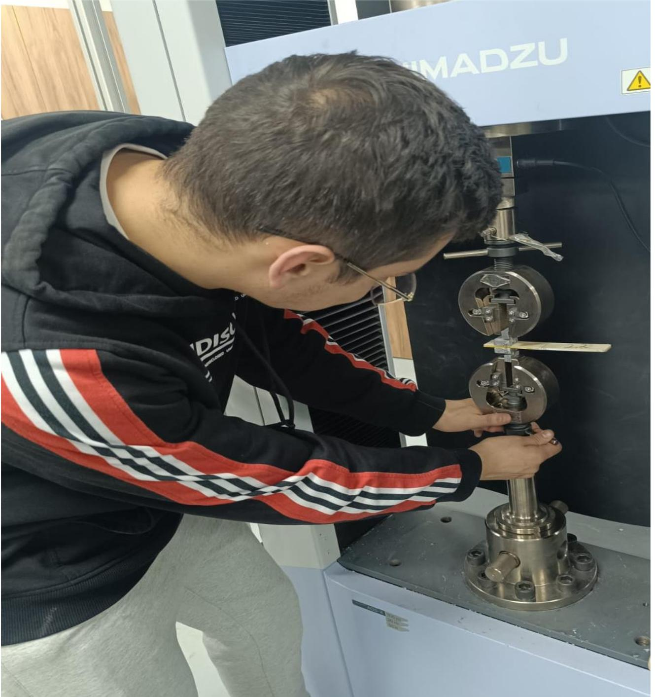
**10.23.** Colocación de la probeta en la máquina de ensayos universal.
