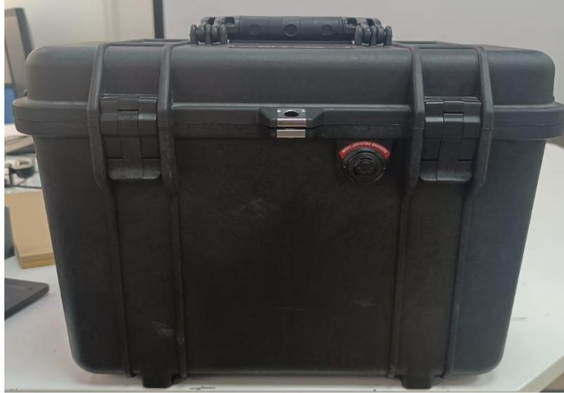
**Figura 25.** Dry Box con bolsas desecantes para capturar humedad.
