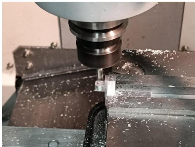
**Figura 10.** Mecanizado CNC del bloque de carga
