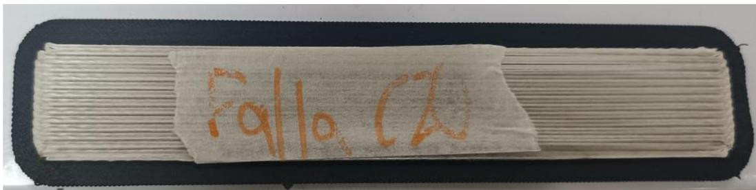
**10.11.** Probeta falla capa 20
