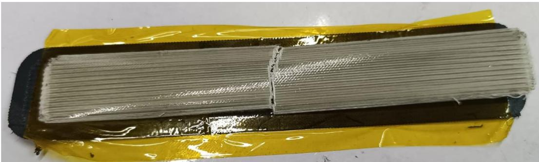
**10.10.** Probeta falla durante procedimiento manufactura
