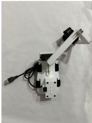
En la figura 16, se observa la parte lateral del dispositivo de rehabilitación de muñeca. En esta vista se puede notar la caja de control, esencial para el funcionamiento del dispositivo, así como el cable de alimentación. La organización de todos los componentes asegura que el dispositivo sea tanto funcional como cómodo para el paciente durante las sesiones de rehabilitación.
