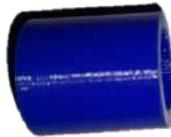
*Nota.* La figura 4-16 muestra el cilindro que cumple la función de unir dos piezas T del espirómetro. Fuente: Elaborado por los Autores, 2024.
