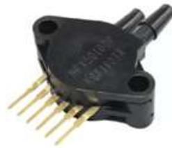
*Nota.* La figura 4-1 indica el componente Sensor MPX5010DP que se empleara para este proyecto técnico. Fuente: [64].
