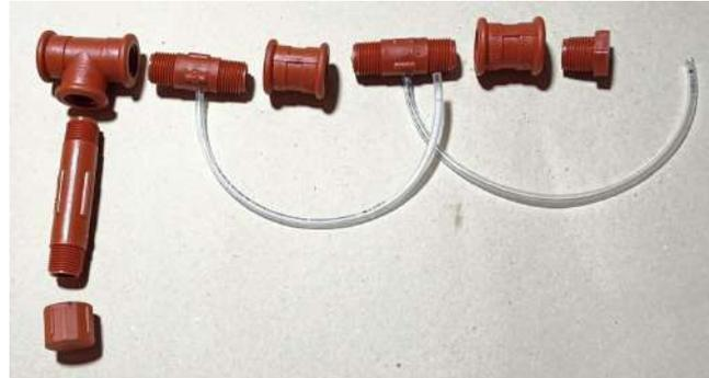
*Nota.* La figura 4-6 muestra el espirómetro desmontado en material de PVC como primer diseño a elaborar. Fuente: Elaborado por los autores.
