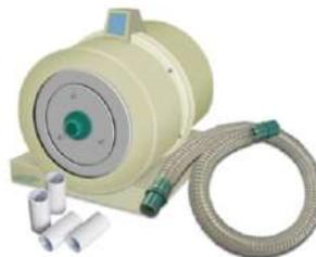
*Nota* En la figura 3-19 se visualiza un espirómetro de Pistón. Fuente: [52].
