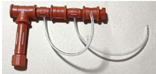
*Nota.* La figura 4-7 es la implementación final del espirómetro en PVC. Fuente: Elaborado por los autores.
