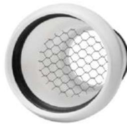
*Nota.* En la figura 4-4 se observa la manera en la que fue colocado la falla de fibra sintética dentro del neumotacógrafo. Fuente: Elaborado por los autores.
