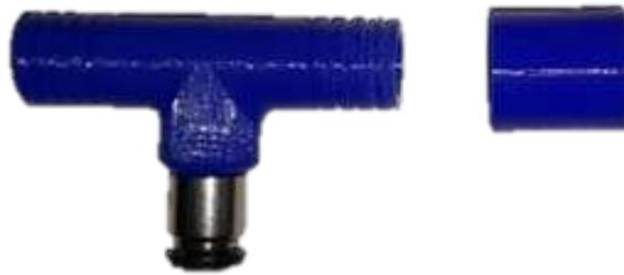
*Nota.* La figura 4-18 se indica la manera en la que va estructurado las piezas en forma de T del espirómetro. Fuente: Elaborado por los Autores, 2024.
