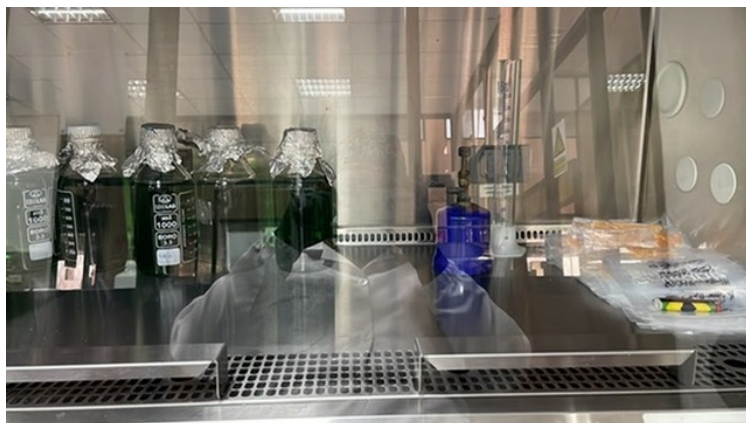
Anexo 11: Colocación de la preparación en la cabina para la reducción de contaminación
