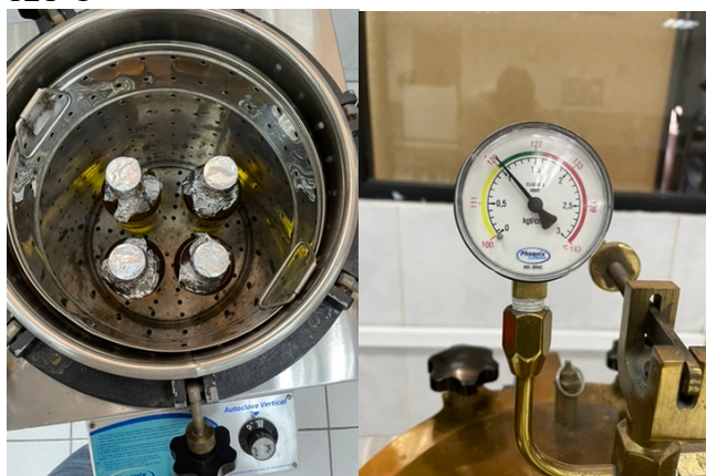
Anexo 7: Colocación al autoclave del enriquecimiento base de Salmonella , durante 15 min a 121°C
