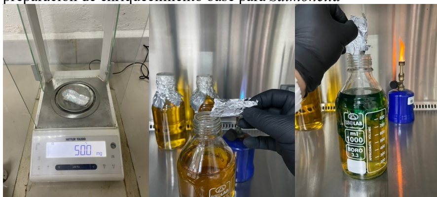
Anexo 10: Pesaje del suplemento para enriquecimiento base para Salmonella e incorporación a la preparación de enriquecimiento base para Salmonella
