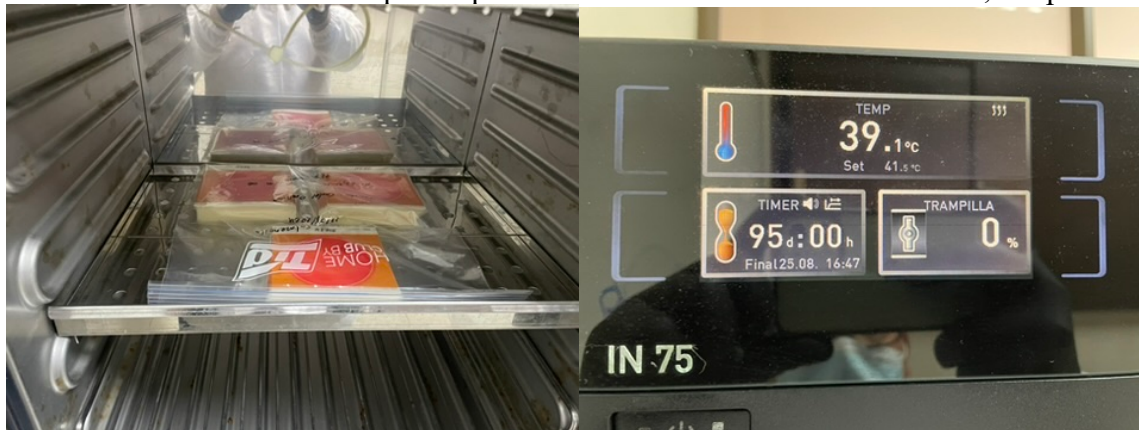
Anexo 16: Colocación de las placas previamente cultivadas en la estufa a 41,5°C por 24 horas
