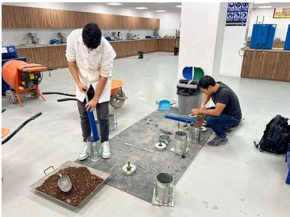
Figura 75 Resultados de ensayos de CBR Calicata 2 25 golpes
