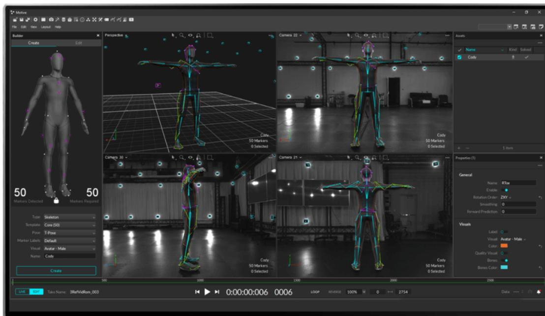
**Nota.** Ilustración del software de captura Optitrack y generación del esqueleto humano. Tomado de [22]
