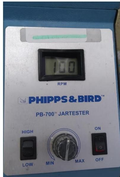
En la imagen número 10 se muestra un equipo de jarras marca Phipps & Bird, modelo PB-700™ JarTester. El dispositivo está configurado para funcionar a 100 revoluciones por minuto (rpm), como se indica en la imagen número 11, Además se puede observar que el equipo cuenta con una perrilla que permite ajustar la velocidad entre los modos mínimo y máximo.
