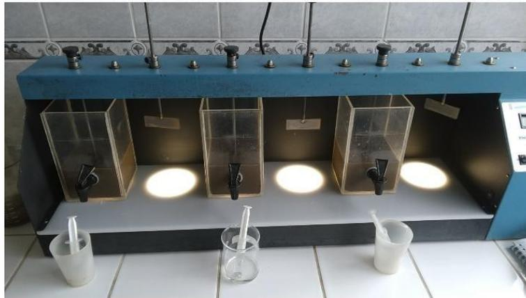
Antes de añadir ácido sulfúrico a las muestras, estas se mezclaron durante 15 minutos a una velocidad de 100 revoluciones por minuto utilizando el equipo de jarras, (Imagen 10), con el objetivo de alcanzar una mezcla homogénea (Villegas et al., 2018).
