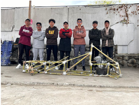
Figura 3. Diseño final en carrizo del chasis Fórmula SAE MATOVELLE Fuente: Autores
