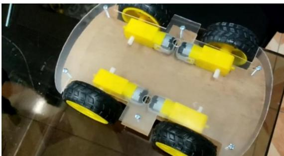
**Figura 4.** Estructura inicial del vehículo teleoperado
