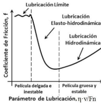
Diagrama del coeficiente de fricción versus el parámetro de lubricación, mostrando diferentes regímenes de lubricación, Fuente: (García, 2016).
