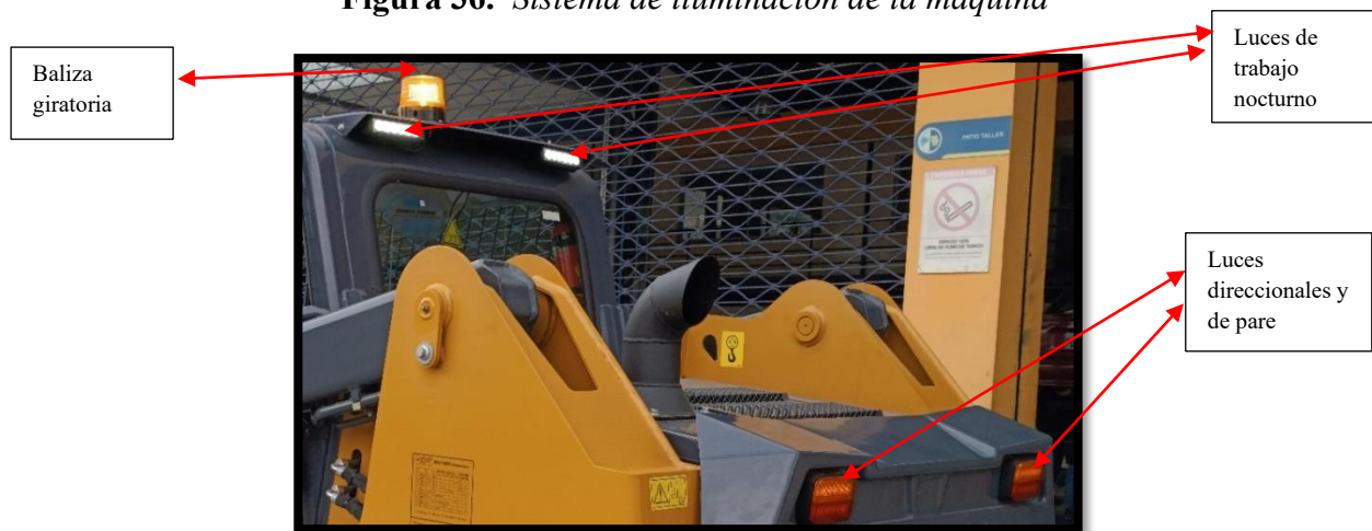
Figura 36. Sistema de iluminación de la máquina
