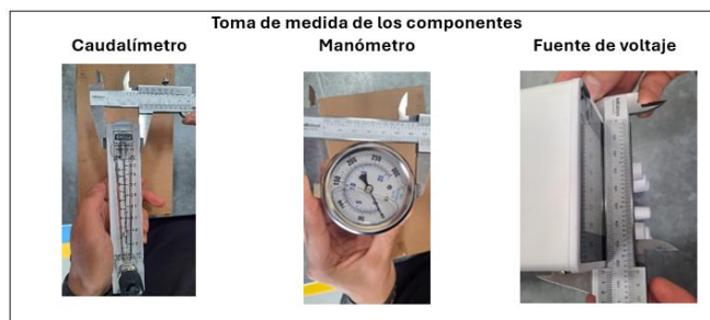
Figura 2.1: Toma de medidas usando pie de rey de los diferentes componentes
