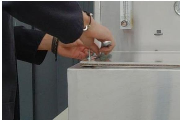
Figura 4.6: Instalación de tapa y empaque
