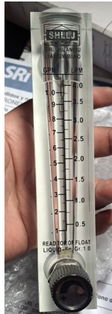
Figura 1.1: Caudalímetro de 0.5 a 4.0 LPM
