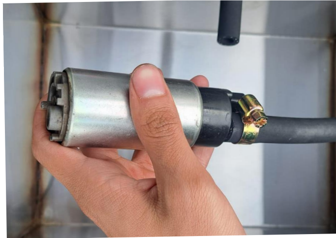
Figura 4.4: Instalación de la electrobomba.
