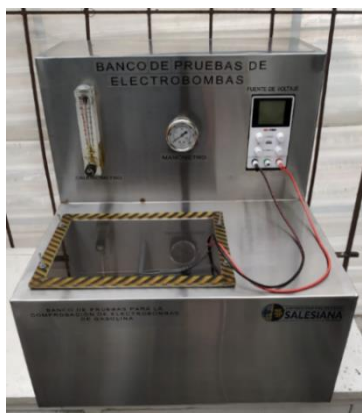
Figura 3.6: Banco de pruebas de electrobombas de gasolina
