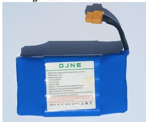
Figura 6: Batería de Litio
