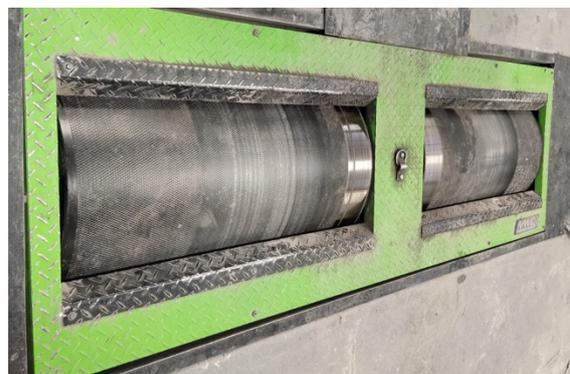
Figura 6. Banco dinamométrico
