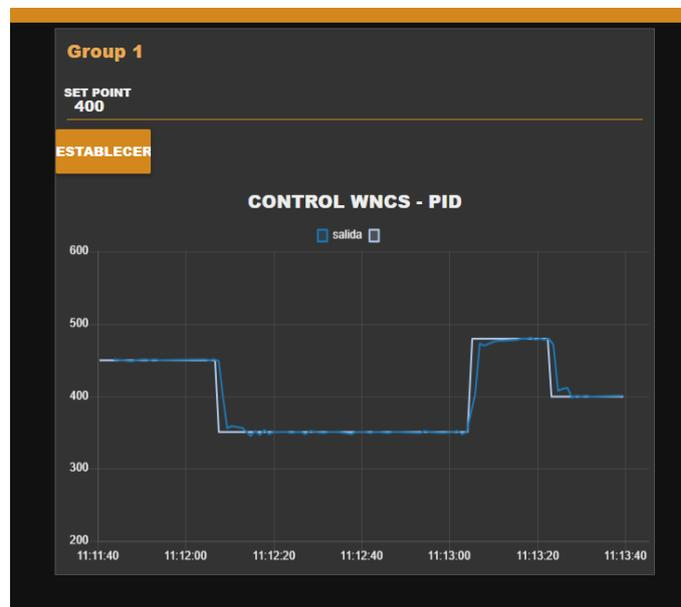
**Fig. 3.** Respuesta de la Función de Transferencia.
