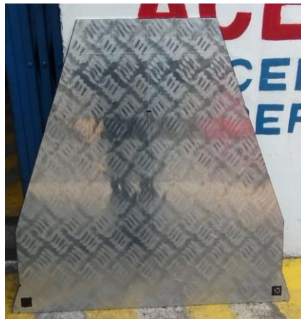
Corte de la forma mamparo por plasma, Fuente: C. Ojeda y C. Quinche
