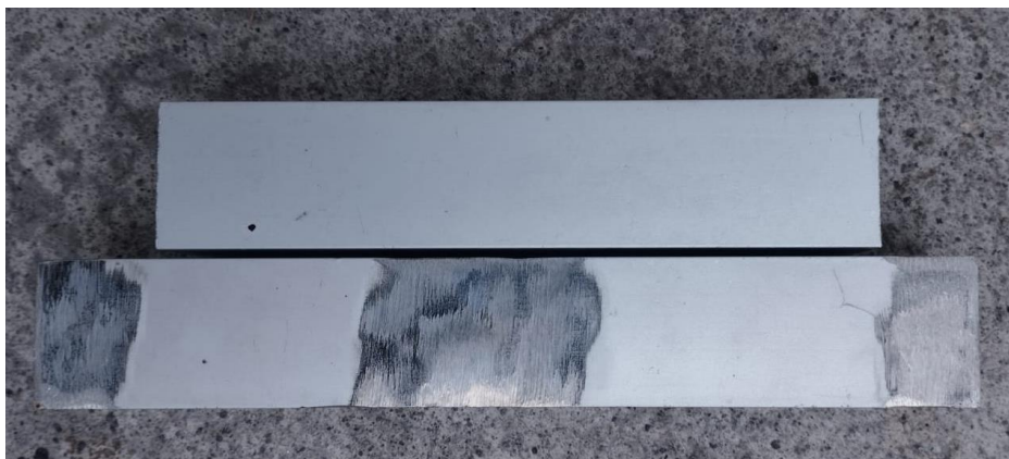
Perfil cuadrado con recubrimiento y perfil sin recubrimiento, Fuente: C. Ojeda y C. Quinche
