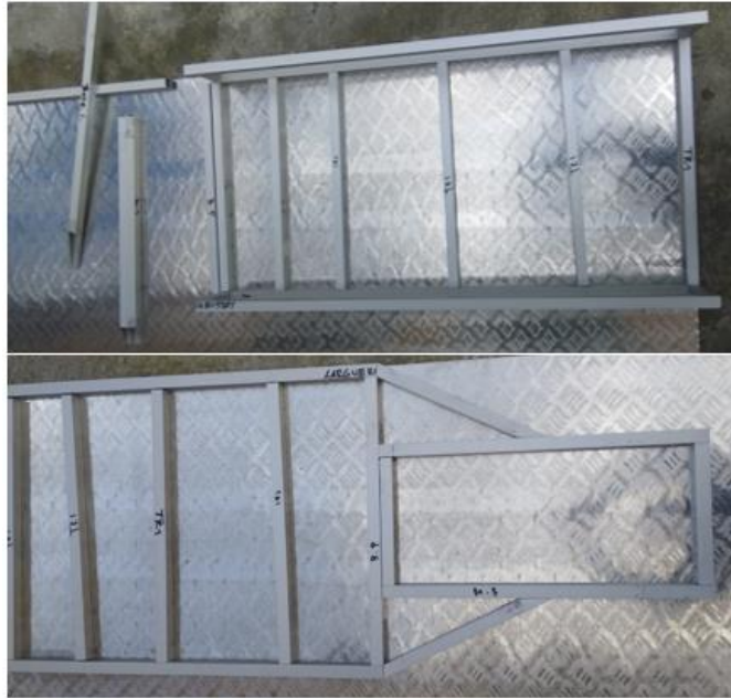
Armado superficial de la estructura del bastidor, Fuente: C. Ojeda y C. Quinche
