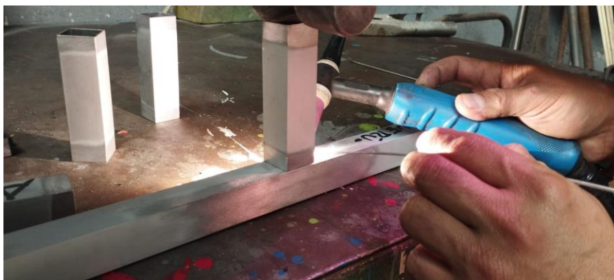
Soldadura del apoya mano del bastidor tipo prototipo, Fuente: C. Ojeda y C. Quinche
