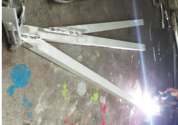
Figura 4.14: Soldadura sección trasera de rueda.
