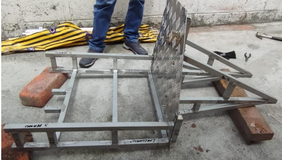
Figura 4.22: Unión perno-tuerca de la sección posterior y primera base conductor.
