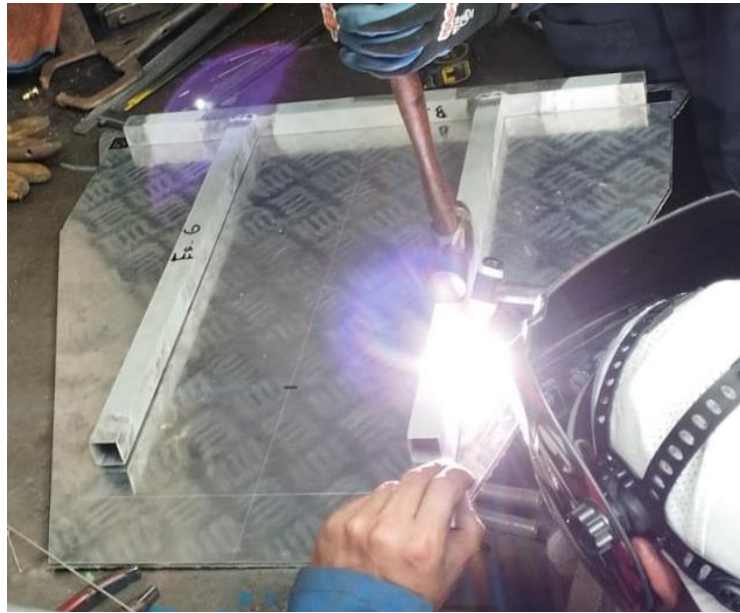
Figura 4.12: Soldadura del mamparo y base posterior.
