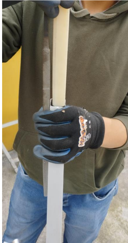
Figura 4.19: Inserción del nylon a estructura tubular
