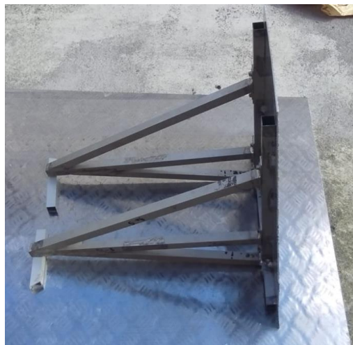
Figura 4.21: Unión perno-tuerca de la sección posterior del bastidor
