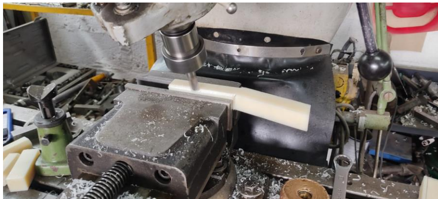
Figura 4.18: Desbaste de vértices de nylon
