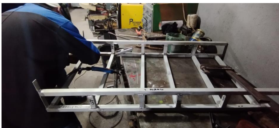
Forma de la estructura del alojamiento del conductor, Fuente: C. Ojeda y C. Quinche
