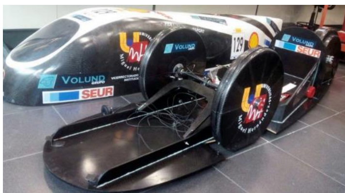
Figura 1.3: Bastidor de fibra de carbono
