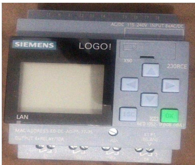
Figura 13. LogoV1 8.3 -PLC, Marca siemens 4 entrada y salidas.
