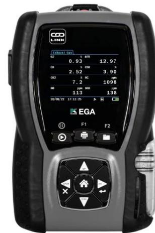
Figura 2. Analizador de gases portátil (Kane EGA-5)
