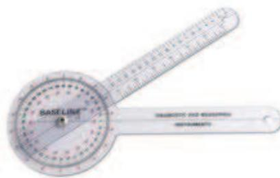
Figura 3.11 Goniómetro analógico [34]
