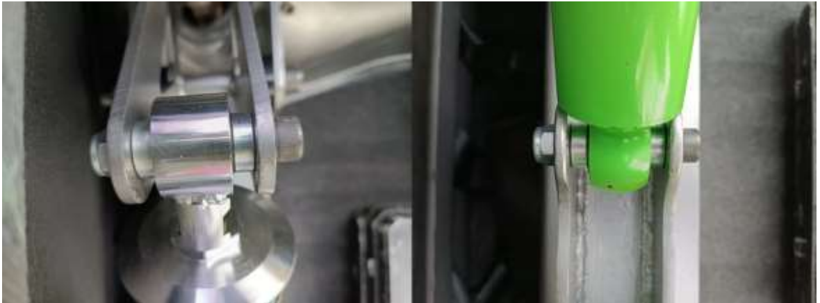
Figura 2.9 Esfuerzo cortante doble en el punto C y D
