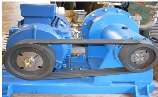
Figura:2.1 Sistema simple de poleas en distribución de máquinas eléctricas rotativas
