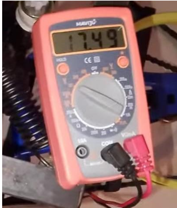
Figura:4.11 Voltaje de salida producida por el generador de voltaje.
