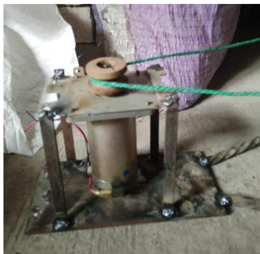
Figura:4.8 Base soldada del generador
