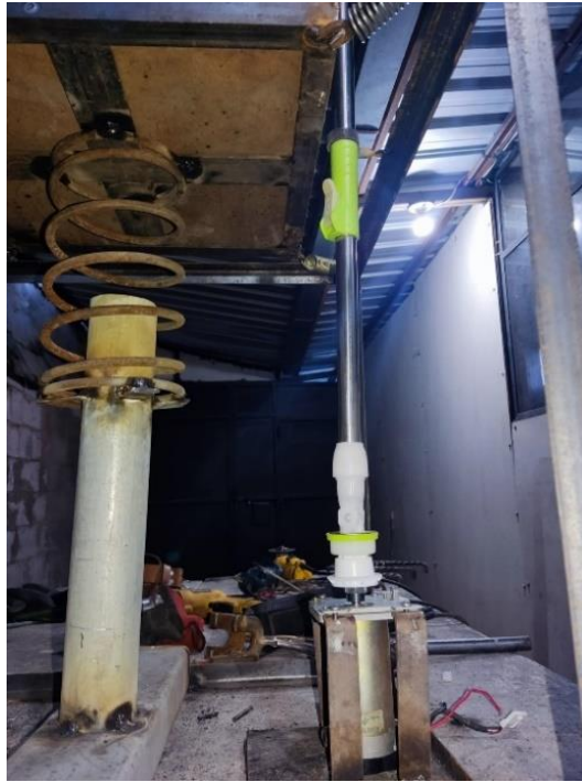
Figura:4.5 Vástago de movimiento vertical Spin Mop
