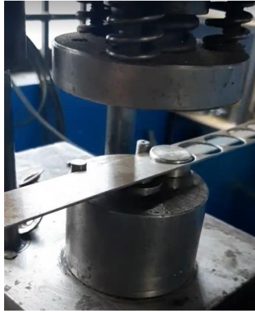
Figura 31. Troquelado de piezas en serie.
