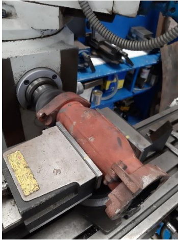
Figura 29. Rectificado de múltiples de escape.
