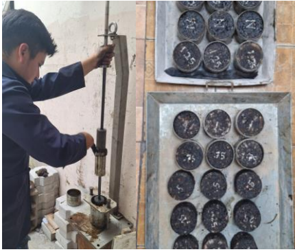
Figura 11. Realización de Briquetas.
