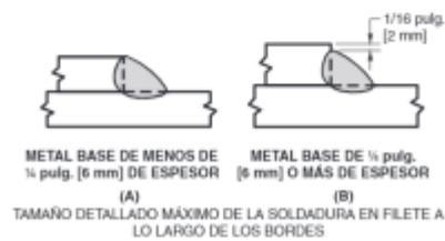
**Figura 4.7**—Tamaño máximo de la soldadura en filete a lo largo de los bordes de las juntas traslapadas (ver 4.4.2.9)
