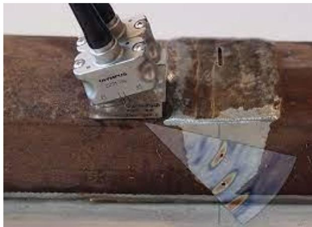
Figura 23 Ultrasonido ejemplificación. Fuente: [16]
