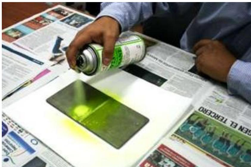
Figura 33 Aplicación tintas penetrantes. Fuente: [34]
