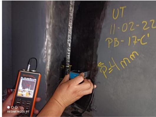
Figura 19 Inspección por ultrasonido. Fuente Autores.
