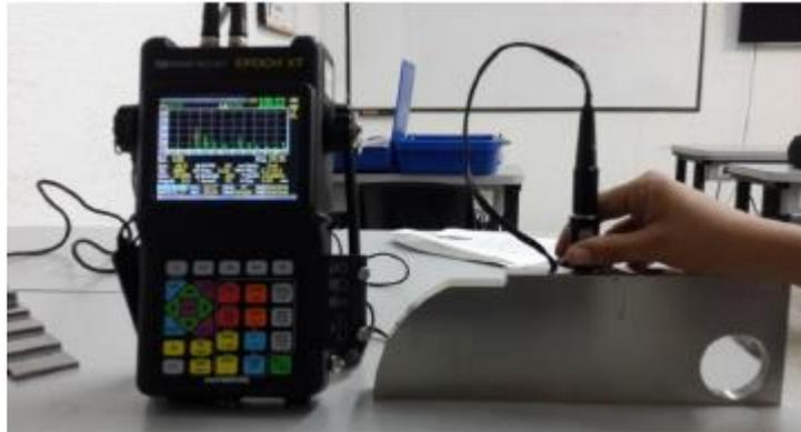
Figura 12 Procedimiento de ultrasonido. Fuente: [44]
