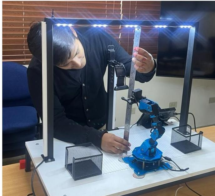
Figura 39. Medición de la posición Final.
