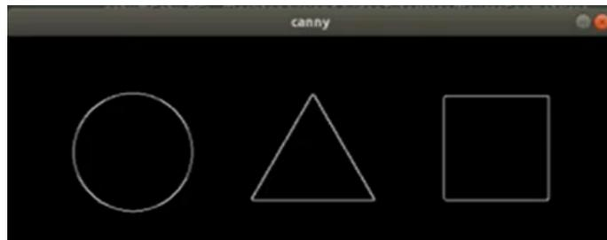
Figura 34. Imágenes resultado de la aplicación del algoritmo de canny.
