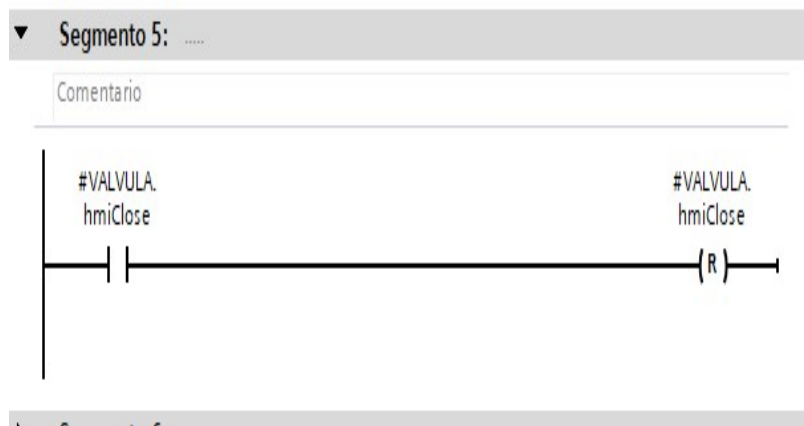
Figura 40. Segmento encargado de cerrar la válvula de llenado.
