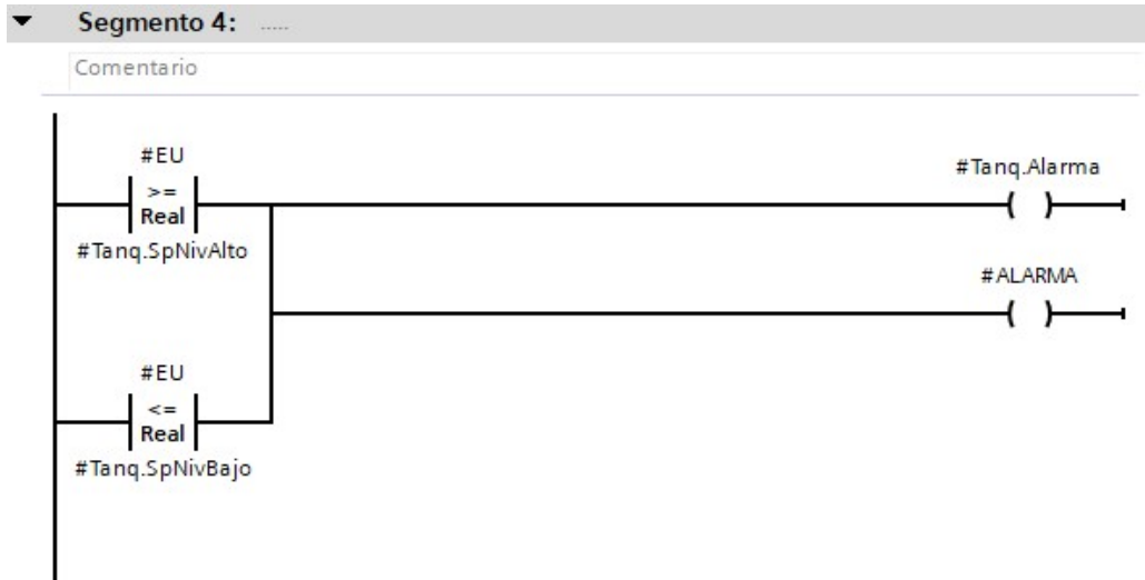
Figura 35. Segmento encargado de comparar el valor de los niveles alto y bajo en las tolvas para encender su respectiva alarma.
