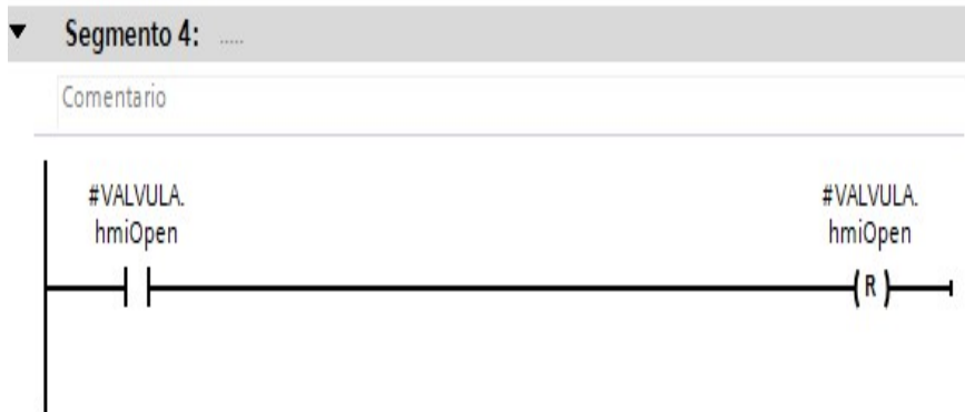
Figura 39. Segmento encargado de abrir la válvula de llenado.
