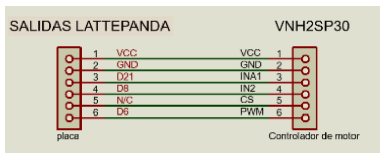
Figura 19 : Conexiones de LattePanda y controlador de motor
