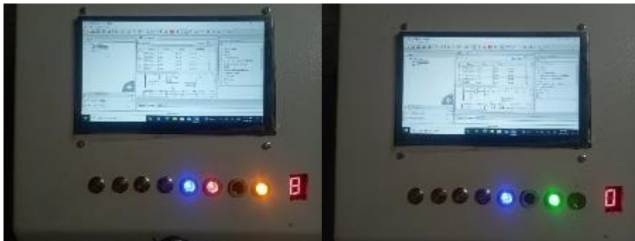
Figura 49 : Accionamiento de código binario display 8- reinicio
