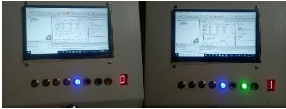
Figura 45 : Accionamiento de código binario display 0-1
