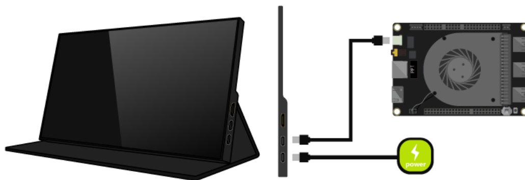
Figura 21 : Conexiones de LattePanda y pantalla 7 pulgadas
