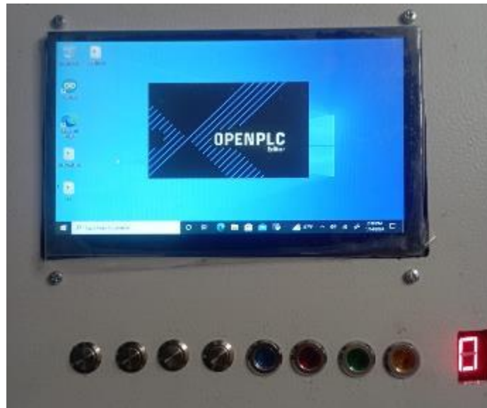
Figura 51 : Ejecución de programa OPENPLC
