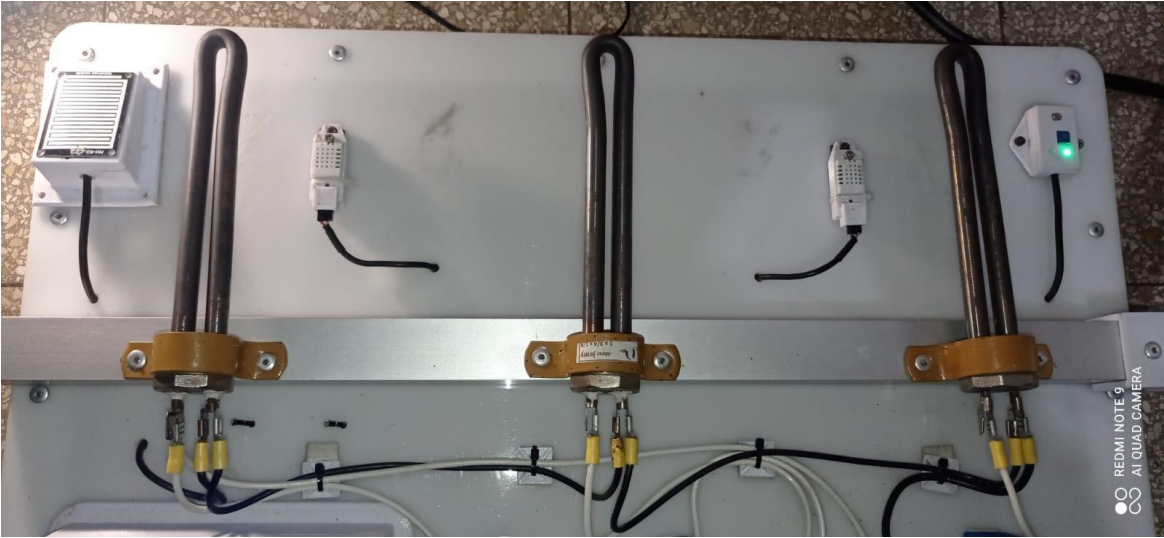
Figura 31 Resistencias para simular temperatura en datacenter
