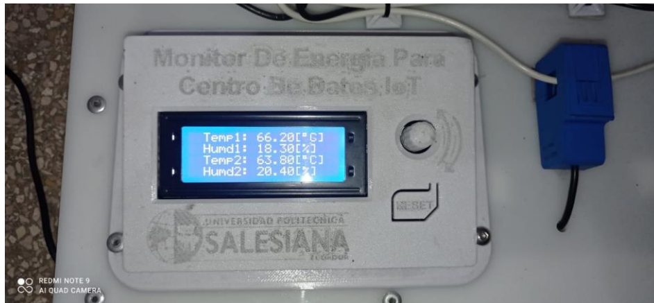
Figura 50 Pruebas con sensores de temperatura y humedad
