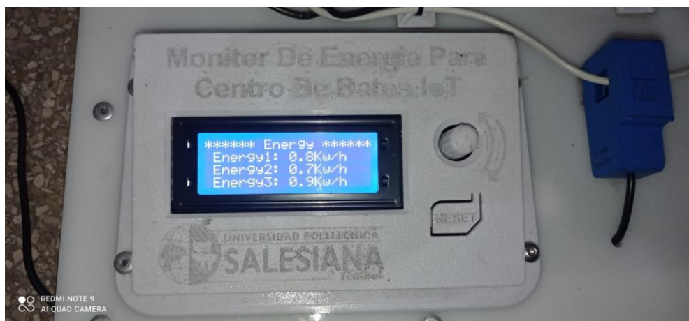
Figura 51 Pruebas con sensores de consumo energético
