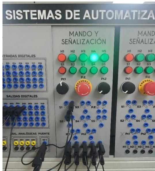
Figura 35: Lamina de mando y señalización.
