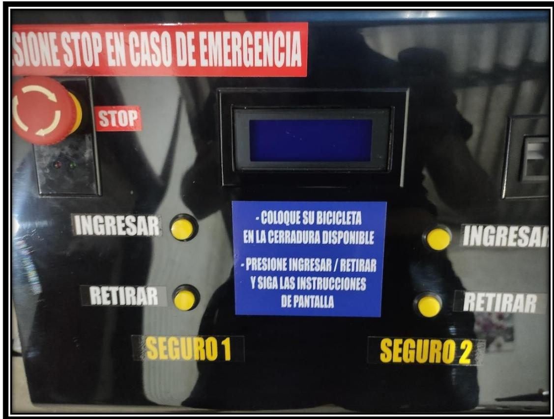
*Nota:* El panel de control cuenta con su pantalla LCD, botoneras de operación, botón de parada de emergencia, sensor dactilar AS608, leds indicadores y sus respectivos etiquetas de las funciones de cada elemento del panel. (Autoría propia, 2024).
