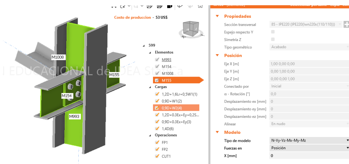
Figura 40. Creación de la conexión viga columna.
