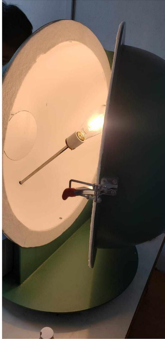
Figura 4.4: Medición de las distintas variables fotométricas de las luminarias.
