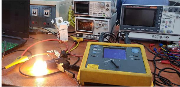
Figura 4.2: Medición de la Distorsión Armónica mediante el Analizador de Redes.
