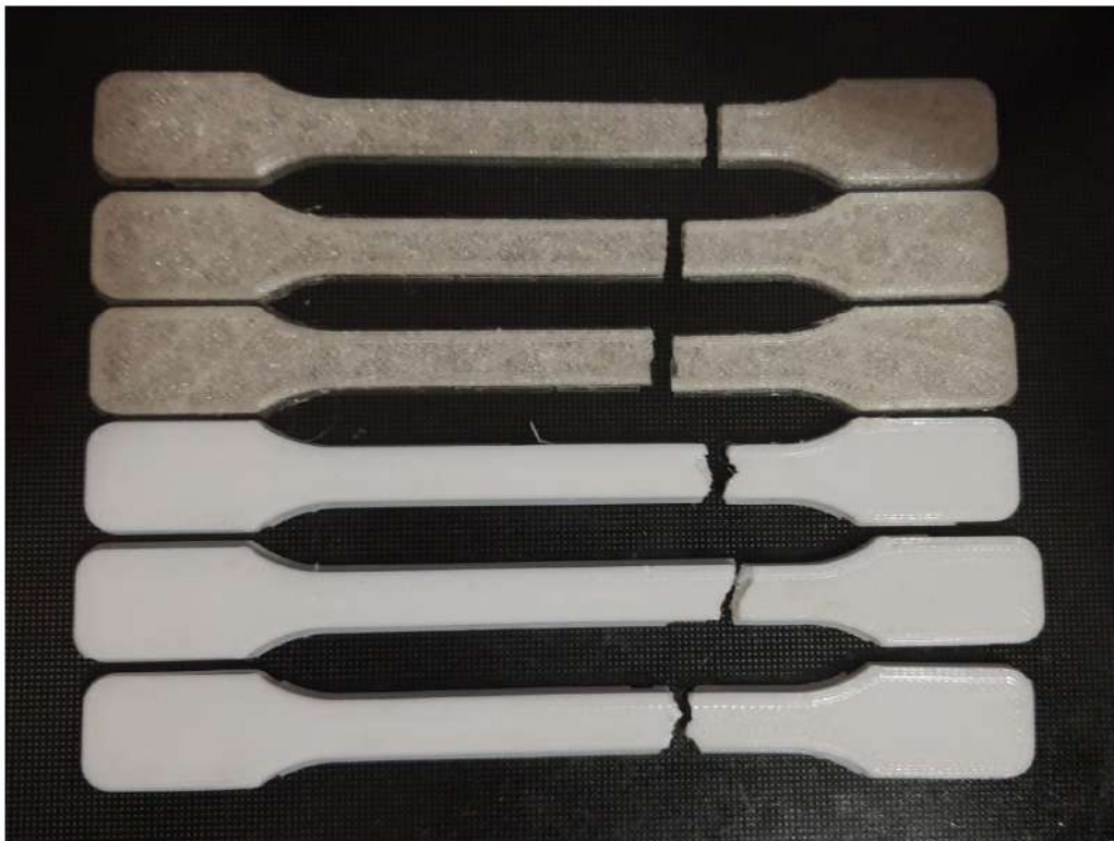
Figura 23. Probetas después de pruebas de tracción
