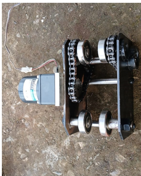
Figura 1. Mecanismo de carrito, Fuente: J.Ramirez, B.Ureta
